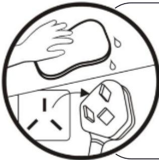
Al limpiar, asegúrese de detener la operación y apagar el interruptor de alimentación. La rueda del ventilador interno gira a alta velocidad, lo que puede causar lesiones.
